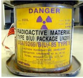
Source changer บรรจุวัสดุกัมมันตรังสีรายการใหม่ขนส่งไปยังประเทศปลายทาง และบรรจุวัสดุกัมมันตรังสีรายการเดิมขนส่งกลับประเทศผู้ผลิต https://www.nde-ed.org/NDEEngineering/RadiationSafety/index.xhtml
