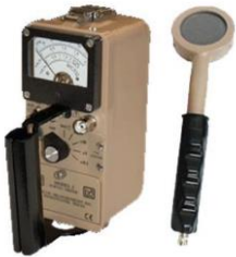
Pancake สามารถใช้ตรวจวัดรังสีแอลฟา บีตา แกมมา
