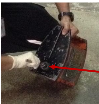
การทำ smear test บริเวณ exit port
