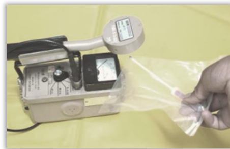
การตรวจสอบการปนเปื้อนทางรังสีที่บริเวณ exit port ด้วย contamination survey meter
