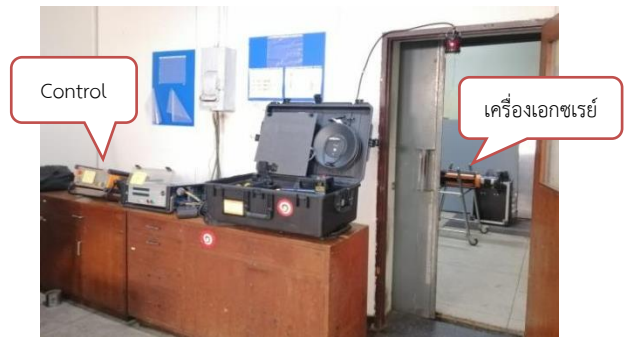
รูปที่ 11(3) ลักษณะการติดตั้งใช้งานเครื่องเอกซเรย์ ในห้องถ่ายภาพรังสี ที่มา กองตรวจสอบทางนิวเคลียร์และรังสี ปี พ.ศ. 2562
