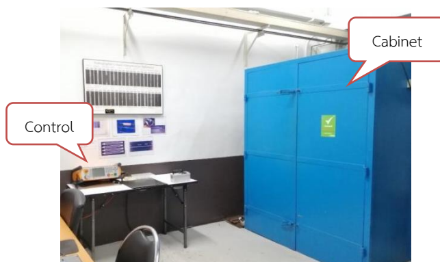
รูปที่ 12(3) ลักษณะการปฏิบัติงานโดยควบคุมการฉายรังสีด้านนอกตู้ปิดมิดชิด ที่มา กองตรวจสอบทางนิวเคลียร์และรังสี ปี พ.ศ. 2561
