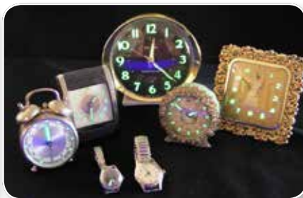
• หน้าปัดนาฬิกาเรืองแสงที่มีเรเดียม-226 (Ra-226) ทริเทียม-3 (H-3) หรือโพรเมเทียม-147 (Pm-147)
