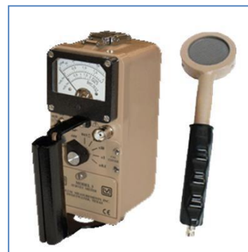
เครื่องสำรวจรังสี (เครื่องมือตรวจ ติดตามปริมาณรังสีในสถานปฏิบัติงานและการเฝ้ารังสี)
