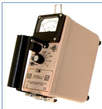
เครื่องสำรวจรังสี (เครื่องมือตรวจ ติดตามปริมาณรังสีในสถานปฏิบัติงานและการเฝ้ารังสี)
