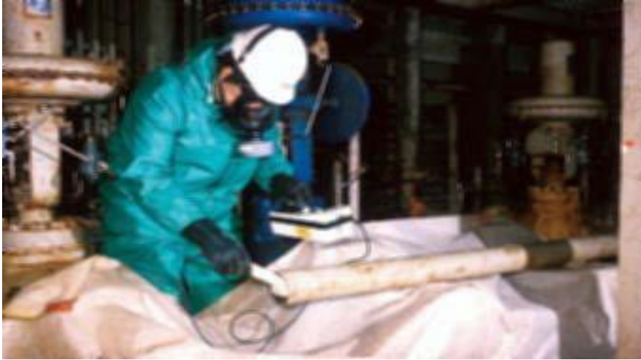
ภาพที่ 3 การตรวจวัดการปนเปื้อนสารกัมมันตรังสีที่มาจาก NORM ที่พื้นผิวภายในท่อ (tubular) โดยใช้ Surface contamination meter หัววัดสำหรับรังสีบีตา (courtesy : National Radiological Protection Board, UK) (ภาพจาก Safety Reports Series No. 34, IAEA, Vienna (2003))
