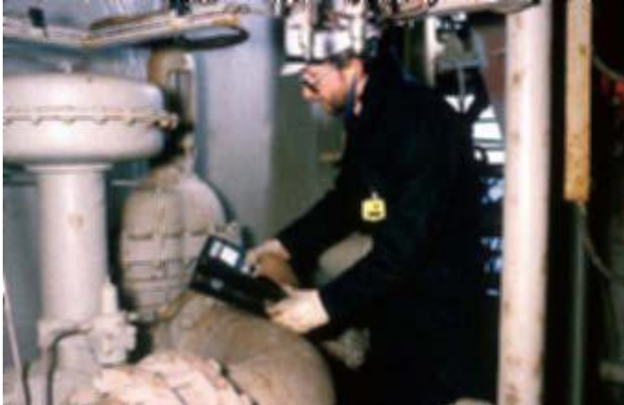
ภาพที่ 1 การเฝ้าตรวจติดตามปริมาณรังสีในสถานปฏิบัติงาน และเฝ้าตรวจการปนเปื้อนรังสีที่เกิดจาก NORM (ภาพจาก Safety Reports Series No. 34, IAEA, Vienna (2003))
