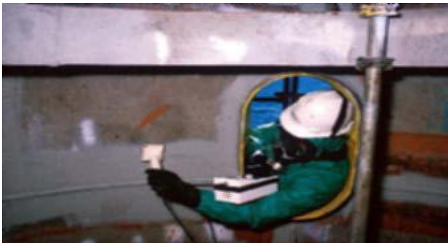
ภาพที่ 2 การตรวจวัดการปนเปื้อนสารกัมมันตรังสีที่มาจาก NORM ที่พื้นผิวภายในภาชนะหรือถัง (vessel) โดยใช้ Surface contamination meter หัววัดสำหรับรังสีบีตา (courtesy : National Radiological Protection Board, UK) (ภาพจาก Safety Reports Series No. 34, IAEA, Vienna (2003))
