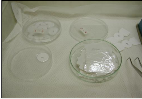
การวัดการเปื้อนบนพื้นผิวของสถานปฏิบัติการทางนิวเคลียร์ด้วย GM Counter (มณฑา ปุณณชัยยะ, Final Report of 20 th Instructor Training Program, NuTEC, JAEA, Tokai, Japan)
