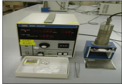
การวัดการเปื้อนบนพื้นผิวของสถานปฏิบัติการทางนิวเคลียร์ด้วย GM Counter (มณฑา ปุณณชัยยะ, Final Report of 20 th Instructor Training Program, NuTEC, JAEA, Tokai, Japan)
