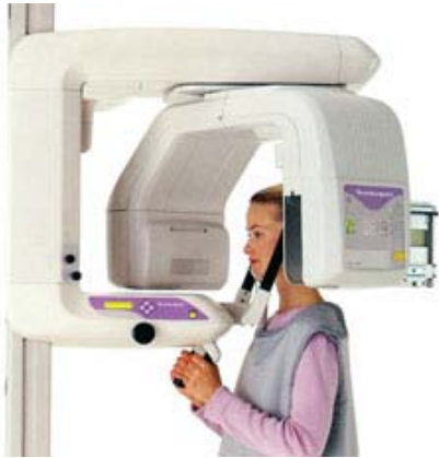
รูปที่ 2 เครื่องเอกซเรย์ฟันชนิด Panoramic และลักษณะการถ่ายภาพรังสีฟัน
